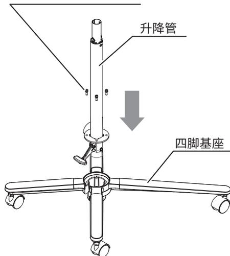
请将升降管插入四脚基座,用附带的螺丝临时固定4个位置。
