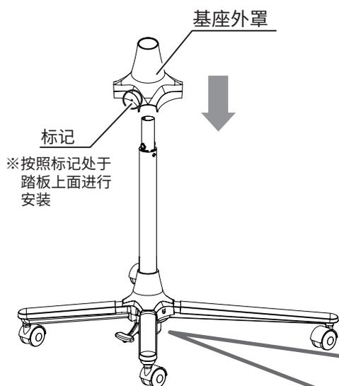
※如上图所示，安装时请让内侧的卡爪卡住基座。
