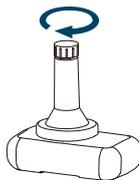
3. Vacíe el depósito de drenaje y asegúrese de que la llave de vaciado esté cerrada.
