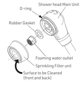
**4** Reassemble the shower head. <Assembling Procedures>
