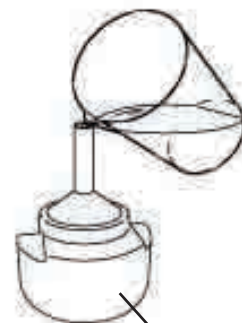
Reservatório de Água
